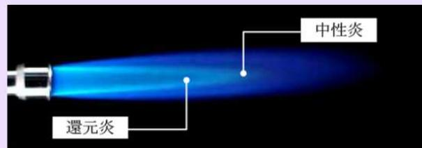
重量や体積の異なる部品どうしのろう付けでは、重いもの（大きいもの）を集中的に加熱します。また、熱伝導率の異なる部品どうしのろう付けでは、熱伝導率の高い部品の方をより多く加熱して下さい。両方の部品を出るだけ速く、そして同時にろう付け温度に達するよう加熱することが重要です。
